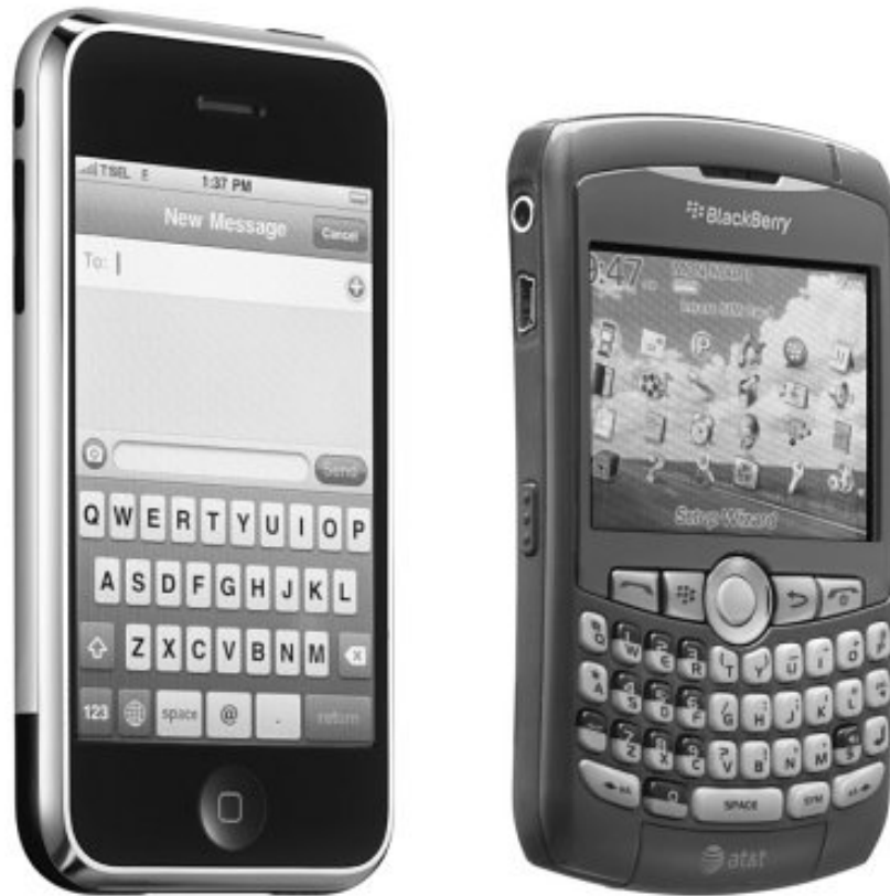
圖 3.4.3：當你比較 2007 年 8 月推出的黑莓機 Curve 8310 和 2007 年 6 月推出的第一代 iPhone 時，就能輕易看出賈伯斯的論點。黑莓機的螢幕只有 2.5 吋，鍵盤超級笨重，螢幕幾乎沒剩什麼空間了。
