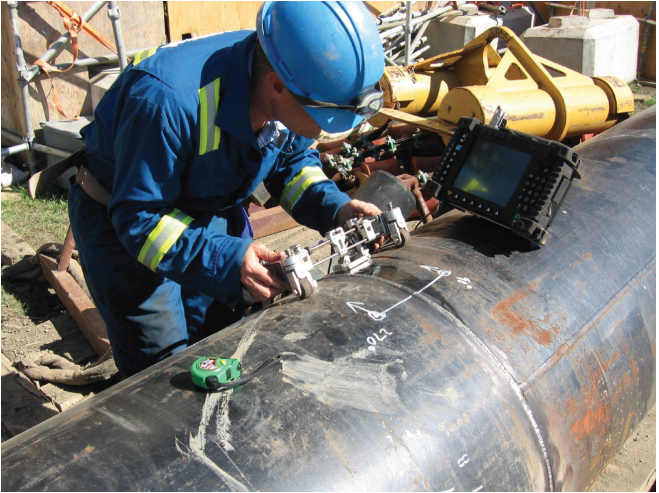
圖20.1 超音波管道檢查
